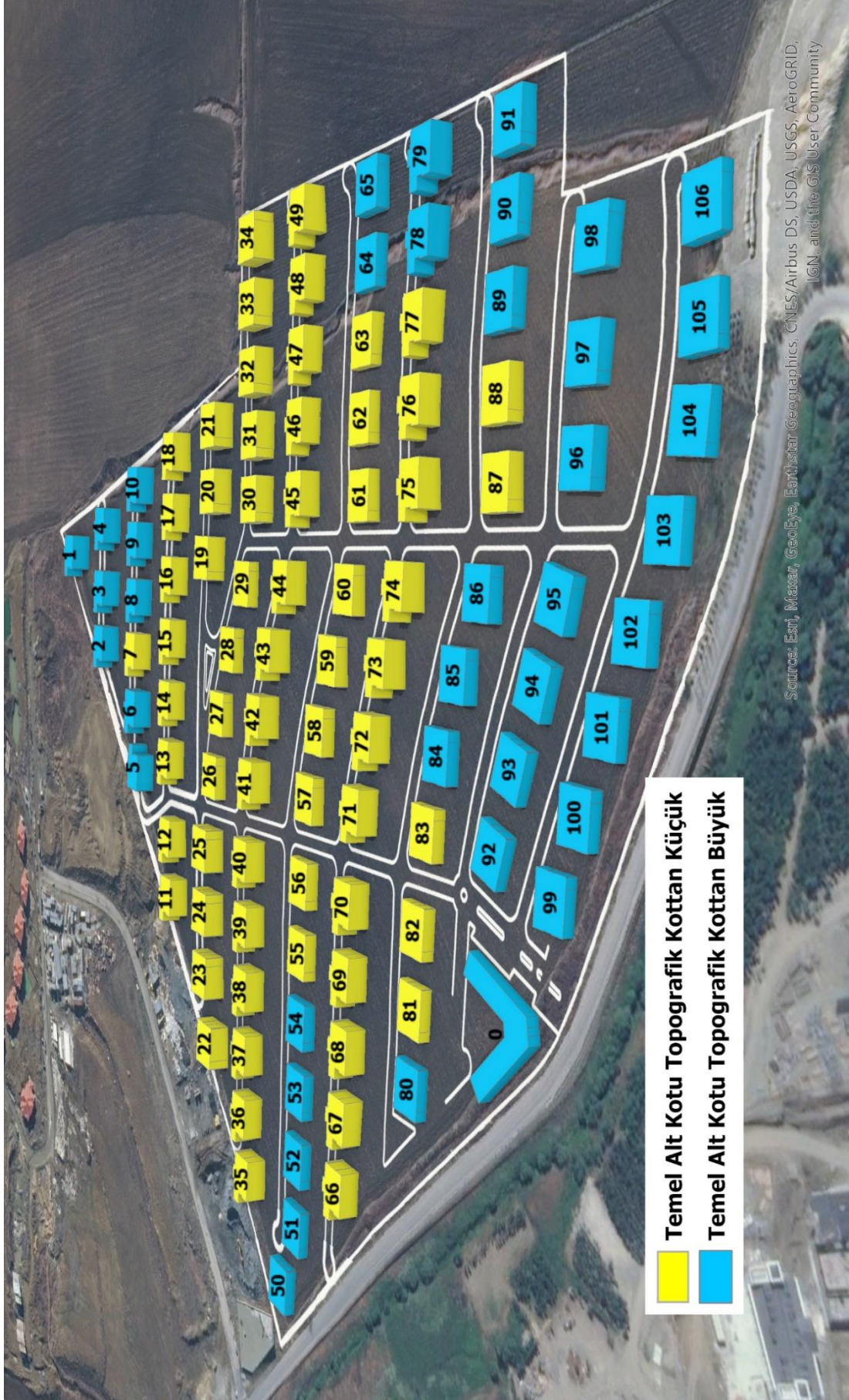
Şekil 6.1. Yapı temel alt kotlarının minimum topografik kotla ilişkisi.
